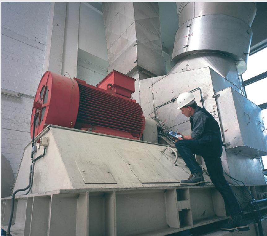
Erfahrungsgemäß sind die Ursachen der Schwingungen in über 50% aller Fälle auf Unwuchten der rotierenden Teile von Maschinen zurückzuführen.
